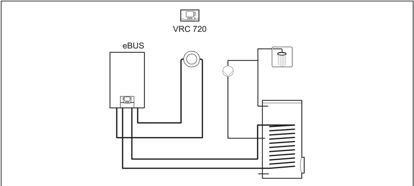
Einfache Systeme mit einem direkten Heizkreis benötigen kein Funktionsmodul.
