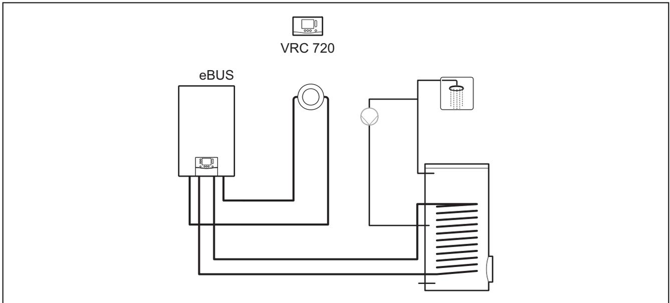
Eenvoudige systemen met een direct CV-circuit hebben geen functiemodule nodig.
