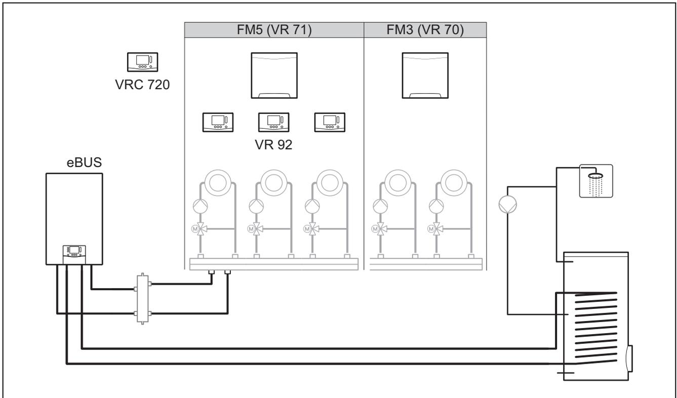
Les systèmes qui comportent plus de 2 circuits chauffage mitigés nécessitent un module de fonction FM5.
