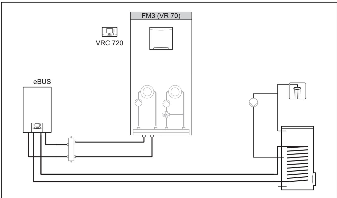
Les systèmes avec deux circuits chauffage qui doivent être régulés indépendamment l'un de l'autre nécessitent un module de fonction FM3.
