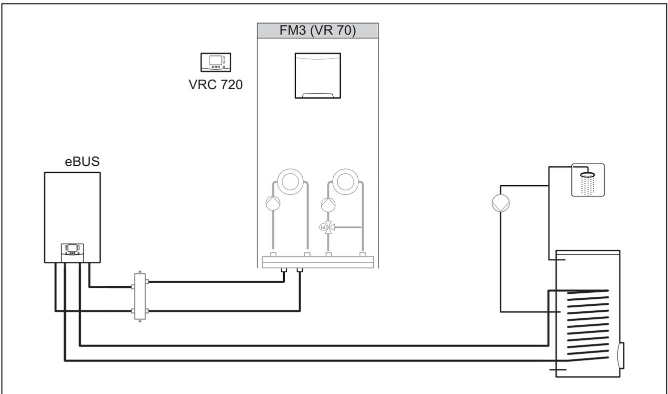
Systeme mit zwei Heizkreisen, die getrennt voneinander geregelt werden müssen, benötigen das Funktionsmodul FM3. Das System ist nicht mit der Fernbedienung **VR 92** erweiterbar.
