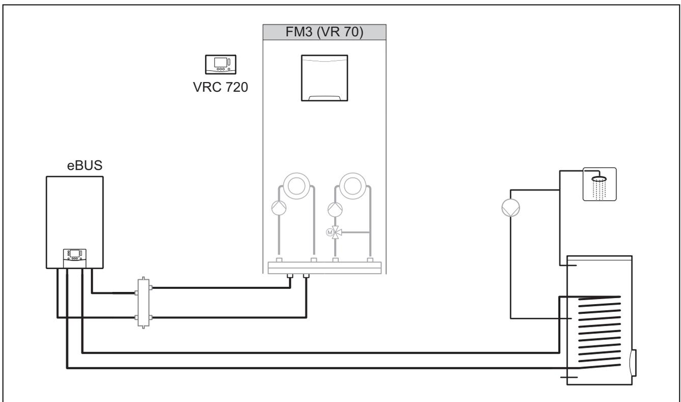
Systemen met twee CV-circuits, die gescheiden van elkaar geregeld moeten worden, hebben de functiemodule FM3 nodig. Het systeem kan niet worden uitgebreid met de afstandsbediening **VR 92**.
