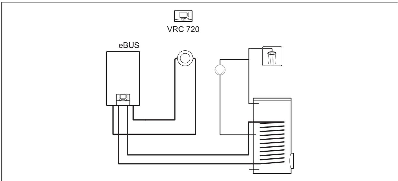
Les systèmes simples avec un circuit chauffage direct ne requièrent aucun module de fonction.
