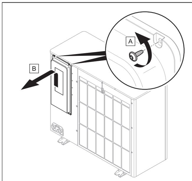
1. Attenzione: la copertura contiene un'impermeabilizzazione rilevante ai fini della sicurezza, che deve essere efficace in caso di perdite nel circuito frigorifero.
