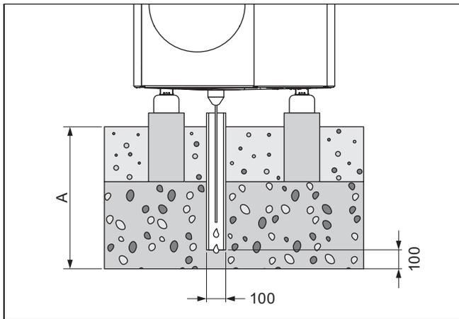
Dans une région où le sol gèle, la cote A  $\geq$  900 mm. Si le sol ne gèle pas, la cote A  $\geq$  600 mm.
