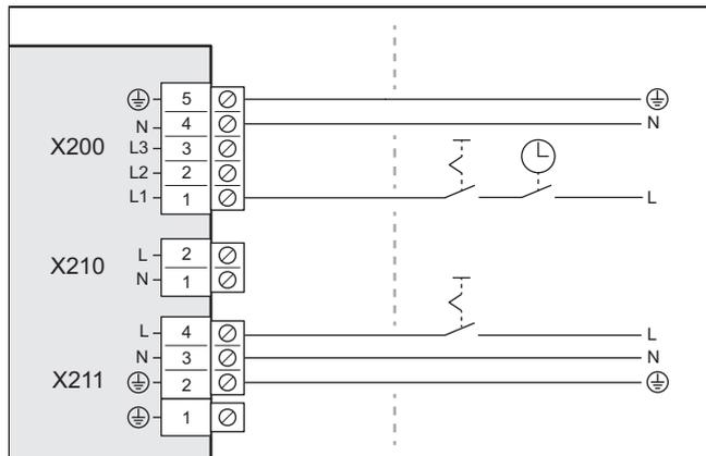
2. Installieren Sie für das Produkt im Gebäude ein Trennschütz, wie in der Abbildung dargestellt.
