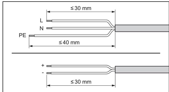
2. Entmanteln Sie die elektrische Leitung wie in der Abbildung dargestellt. Achten Sie dabei darauf, die Isolierungen der einzelnen Adern nicht zu beschädigen.
