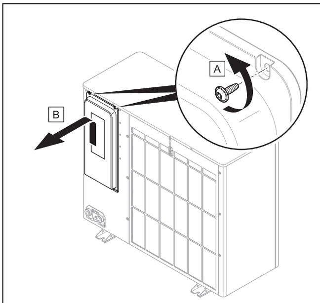
1. Beachten Sie, dass die Abdeckung eine sicherheitsrelevante Abdichtung enthält, die bei einer Undichtigkeit im Kältemittelkreis wirksam sein muss.
