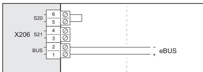
3. Collegare il cavo eBUS con l'attacco X206, BUS.
