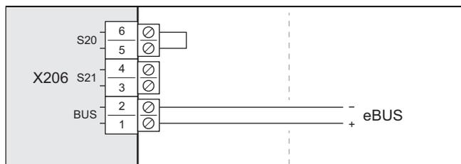
3. Schließen Sie die eBUS-Leitung am Anschluss X206, BUS an.
