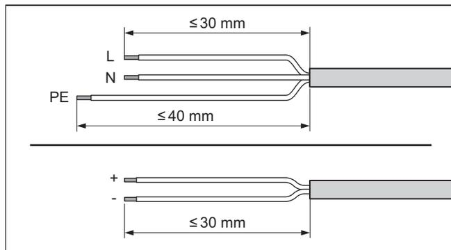
2. Strip de elektrische leiding af zoals weergegeven in de afbeelding. Let er hierbij op dat de isolatie van de verschillende aders niet wordt beschadigd.
