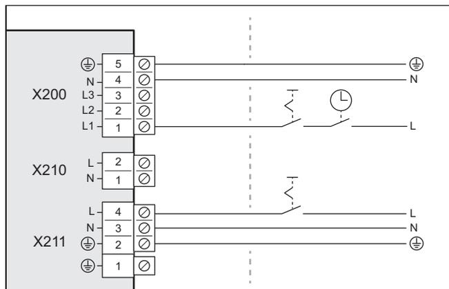
2. Per il prodotto installare nell'edificio un contattore di sezionamento come illustrato in figura.
