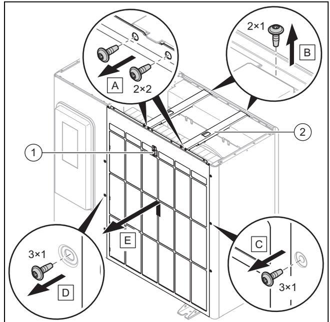
1. Staccare il collegamento elettrico sul sensore della temperatura (1).
