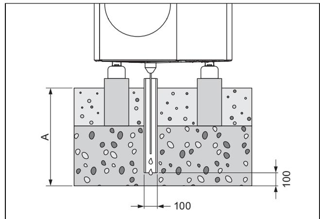
Das Maß A beträgt für eine Region mit Bodenfrost  $\geq 900$  mm, und für eine Region ohne Bodenfrost  $\geq 600$  mm.
