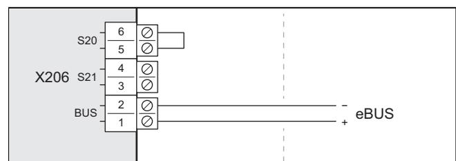
3. Sluit de eBUS-leiding op de aansluiting X206, BUS aan.
