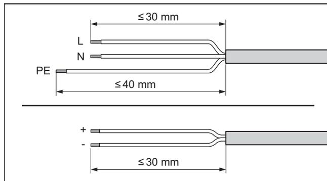
2. Rimuovere la linea elettrica, come indicato in figura. Evitare di danneggiare l'isolamento termico dei singoli cavi.
