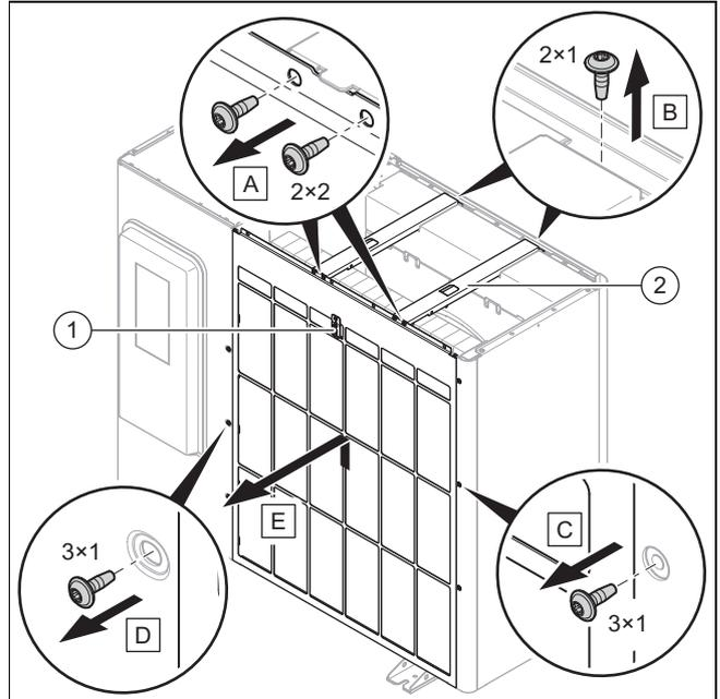
1. Trennen Sie die elektrische Verbindung am Temperatursensor (1).
