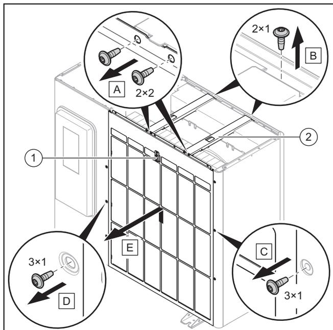
1. Koppel de elektrische verbinding aan de temperatuursensor (1) los.
