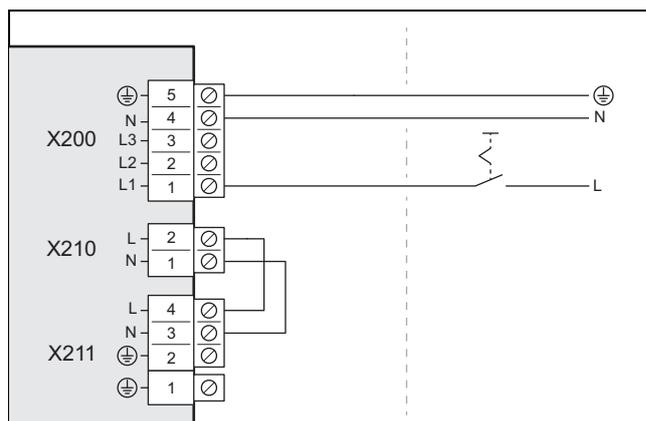
2. Nell'edificio installare per il prodotto un dispositivo di separazione elettrico, come indicato nell'illustrazione.
