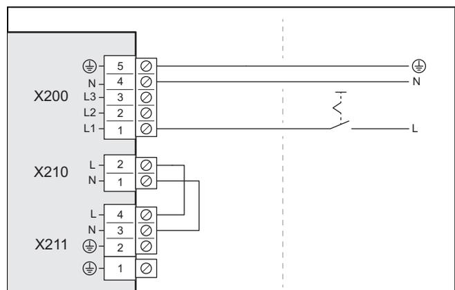
2. Installieren Sie für das Produkt im Gebäude einen Trennschalter, wie in der Abbildung dargestellt.
