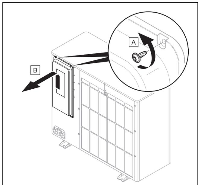
1. Let erop dat de afdekking een veiligheidsrelevante afdichting bevat, die bij een lekkage in het koudemiddelcircuit optimaal moet werken.
