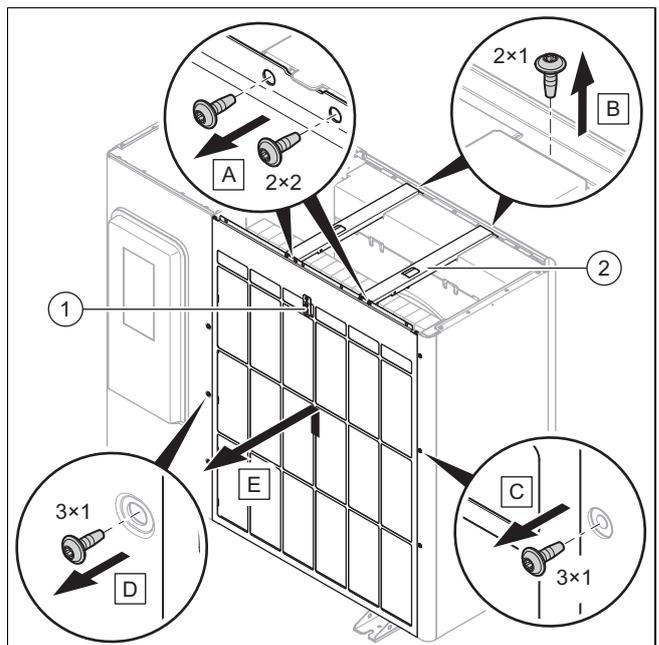
1. Débranchez le raccordement électrique du capteur de température (1).
