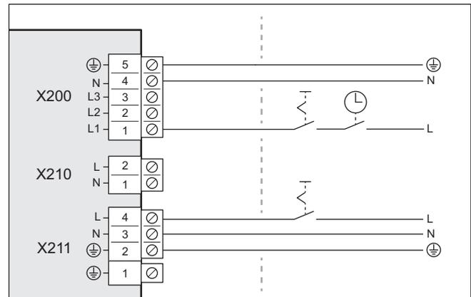
2. Installeer voor het apparaat in het gebouw een scheidingschakelaar zoals weergegeven op de afbeelding.
